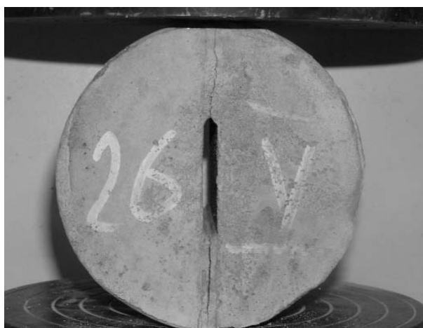
Рис. 2. Схема навантаження циліндричного зразка з концентратором напружень (а) і загальний вигляд суцільної тріщини при його руйнуванні (б)
