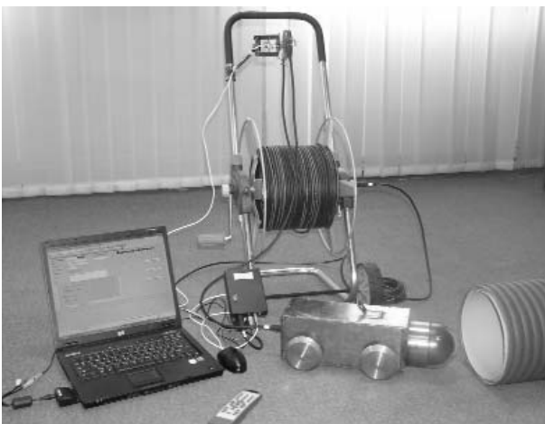
Рис. 3. Загальний вигляд складових діагностичної системи СВД-1: ноутбук (зліва); самопересувний візок з відеокамерою (справа); механізм подачі кабелю (вгорі)
