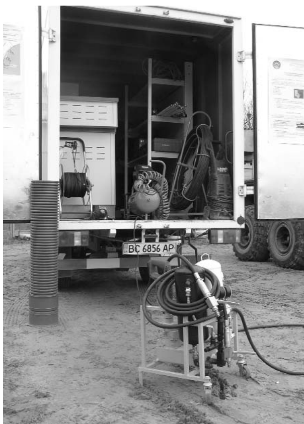
Рис. 4. Установа ІН-1 для ін'єкції поліуретанових композицій (на землі), компресор для подачі стисненого повітря (в автомобілі-фургоні)
