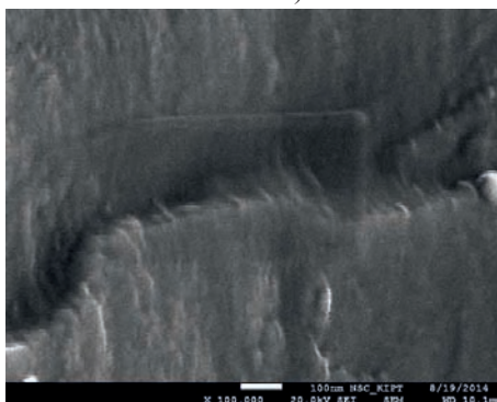
Покрывтие, полученное при T_{oc.} = 495-465^\circ\text{C} (обр. № 429; схема 2)
