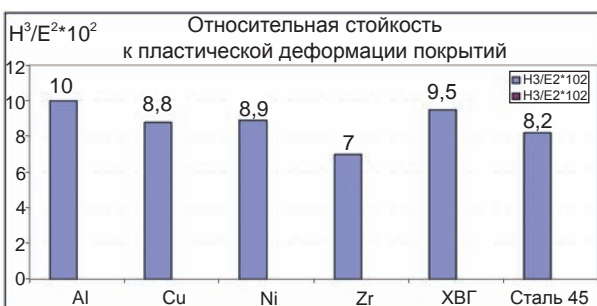
Рис. 5. Гистограммы механических свойств карбидохромовых покрытий и материалов подложек
