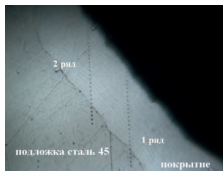
Рис. 6. Схема индентирования поперечного шлифа с покрытием. Расстояние между уколами индентора — 3 мкм
