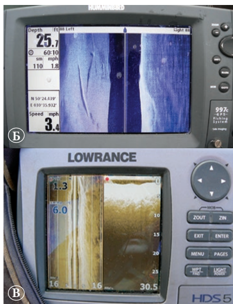
Рис. 2. А. Методика проведення розвідок. Б. Гідролокатор бічного огляду Humminbird 997cx SI Combo. В. Структурсканер Lowrance HDS 5. Г. Видубецьке озеро – РОП 1. Карта глибин відсканована Lowrance HDS 5.
