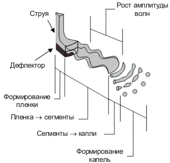
Рис. 7. Схема распада струи в оросителе [19]
