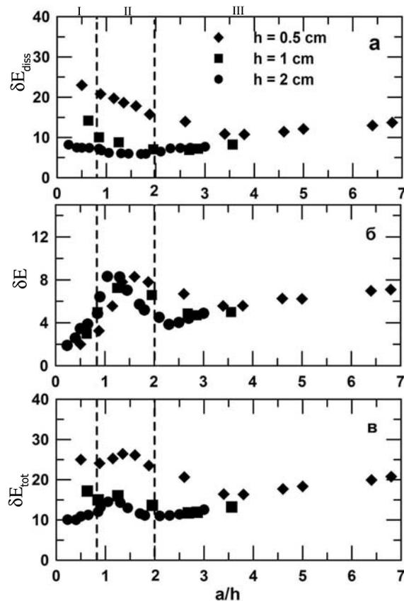
Рис. 11. График зависимости потерь энергии от нормированной амплитуды волны  $a/h$ : а – потери энергии за счет вязкости и диффузии на отрезке  $x_l$ , до  $x_r$   $\Delta E_{diss}$ ; б – потери энергии при соударении  $\delta E$ ; в – общие потери энергии  $\Delta E_{tot}$
