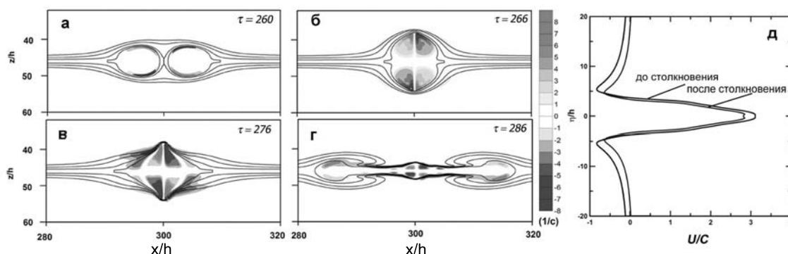
Рис. 5. Взаимодействие внутренних волн второй моды с амплитудой  $a/h = 3.3$  для случая  $h = 0.5$  см: на рисунках (а-г) показана эволюция поля завихренности и поля плотности (представлены изолинии); на рисунке д представлены вертикальные профили скорости по центру волны в сечении  $x_r$  до и после столкновения
