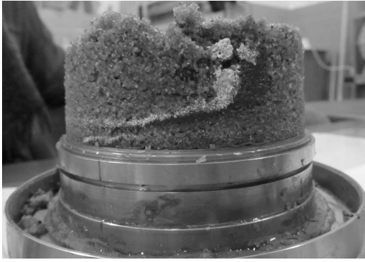
Рис. 2. Зріз водонасиченого крупнозернистого піску
