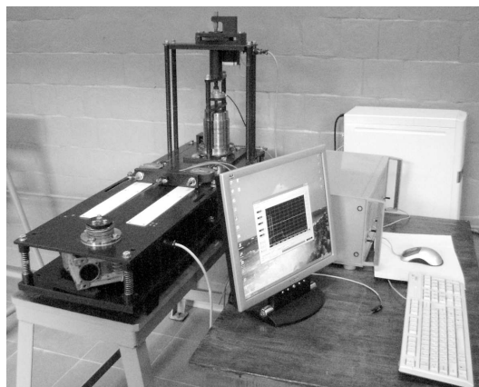
Рис. 1. Загальний вигляд приладу крутіння
