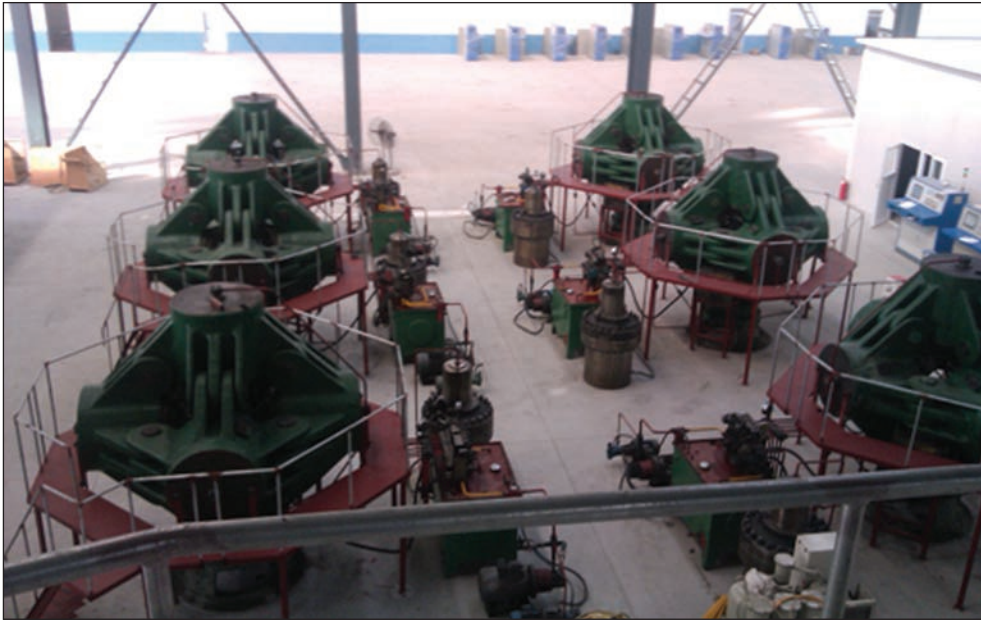
Рис. 6. Загальний вигляд виробничої ділянки для випуску алмазів при комплектуванні 6-пуансонним пресовим обладнанням CS-VII з діаметром плунжера 560 мм і зусиллям 25 МН
