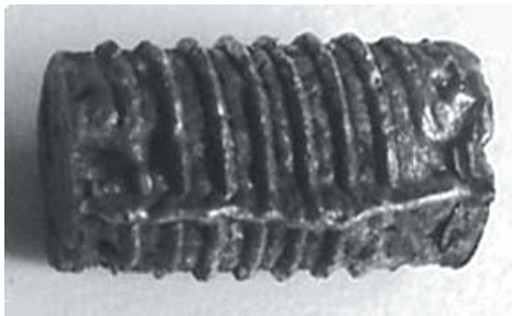
Рис. 10. Резьба, «нарезанная» на железе с использованием АСД в литейной форме из аустенитной нержавеющей стали (виден горизонтальный гребень металла, «затекшего» в зазор разборной формы, диаметр изделия 12 мм)
