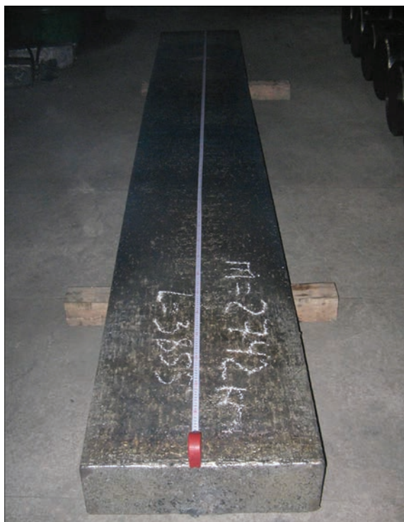
Рис. 6. Внешний вид слитка-сляба сплава ЭП708 размерами 155×540×2500 мм
