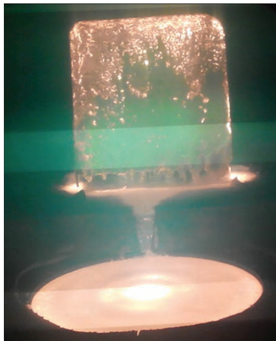
Рис. 2. Процесс ЭЛП жаропрочного сплава на основе никеля ЭИ648
