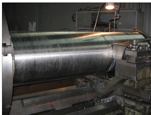
Рис. 4. Механически обработанный слиток диаметром 500 мм жаропрочного сплава на основе никеля ЭИ648
