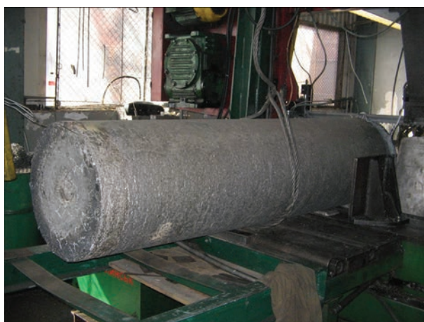
Рис. 3. Слиток диаметром 500 мм жаропрочного сплава на основе никеля ЭИ648
