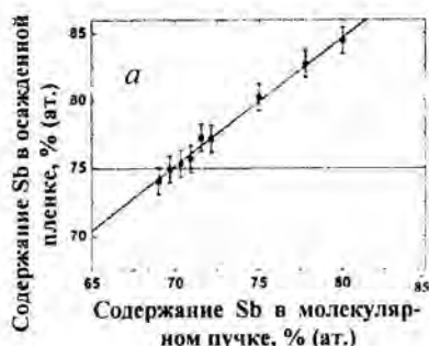
Рис. 1. Зависимость содержания Sb в осажденной пленке от содержания Sb в молекулярном пучке (а) и от температуры нагрева подложки (б).
