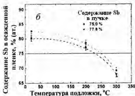
Рис. 1. Зависимость содержания Sb в осажденной пленке от содержания Sb в молекулярном пучке (а) и от температуры нагрева подложки (б).
