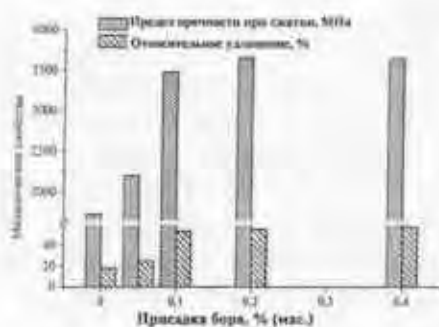
Рис. 4. Механические свойства литых сплавов Ti—36Al с добавками бора.
