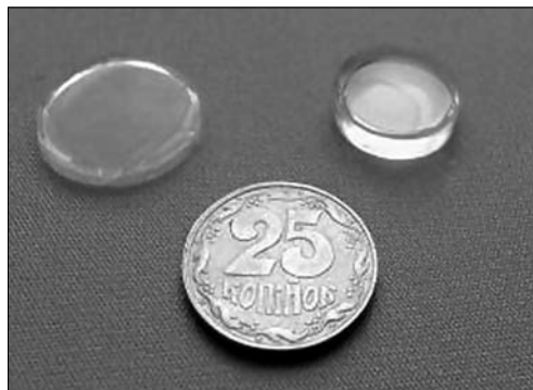
Рис. 2. Високопористі \text{SiO}_2 золь-гель матриці з органічними сцинтиляторами
