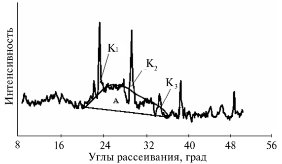
Рис. 4. Рентгенограмма фибры из сплава Fe_{70}Cr_{10}P_{13}C_7 , отражающая наличие аморфной (А) и кристаллической ( K_1, K_2, K_3 ) фаз
