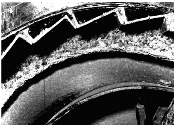
Рис. 3. Ілюстрація самофутерування футерівки барабана при надкритичній частоті його обертання
