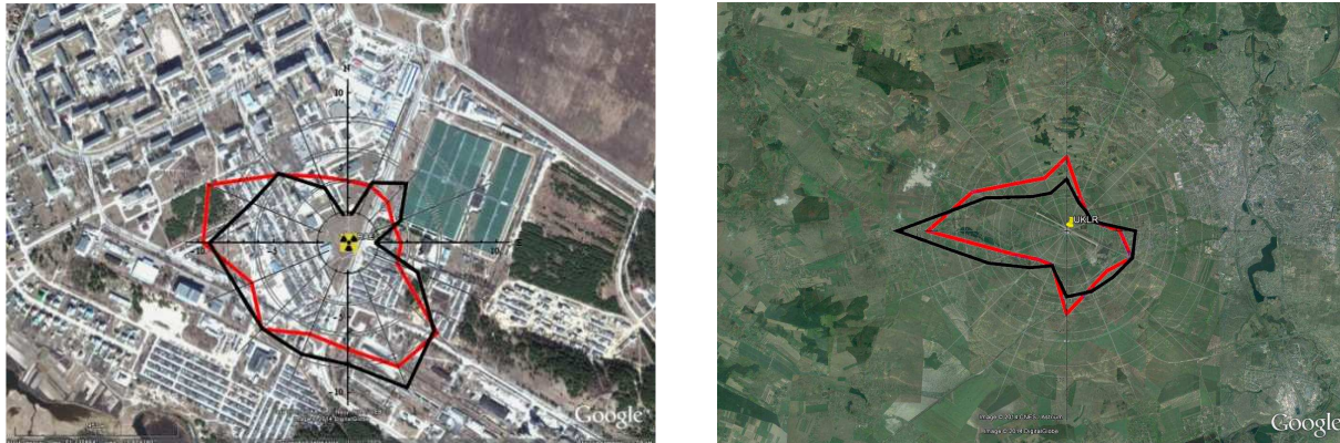
Рис. 1. Роза ветров для метеостанций РАЭС (слева) и Ровенского аэропорта (справа) за 2006-й год, построенная по результатам расчета WRF (толстая красная линия) и по результатам измерений (черная тонкая линия)
