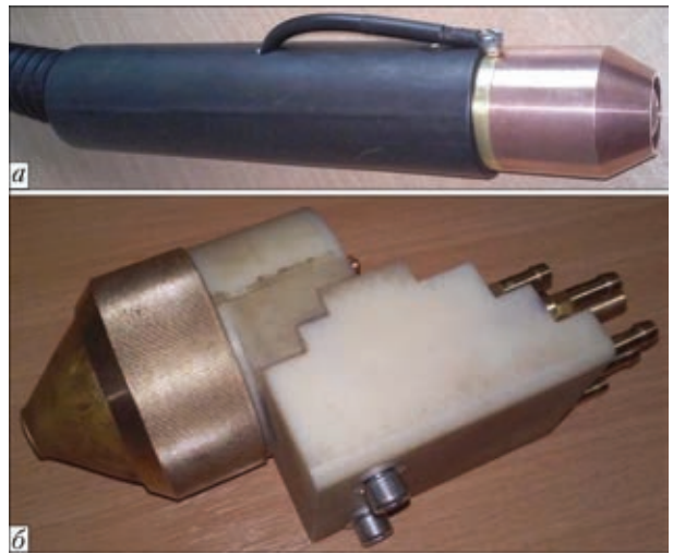
Рис. 17. Плазмтроны разработки ИЭС им. Е.О. Патона для плазменно-дуговой сварки неплавящимся (а) и гибридной плазменно-дуговой сварки плавящимся (б) электродами
