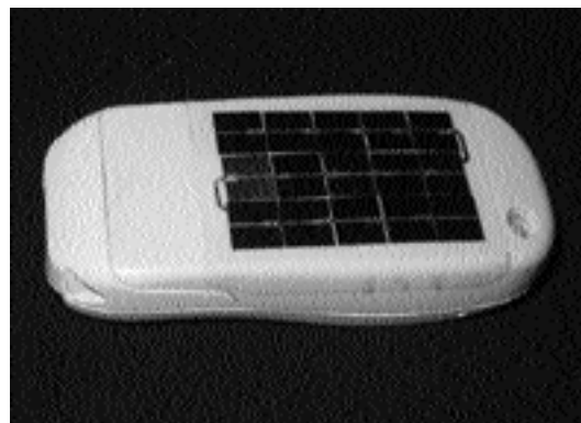
Рис. 7. Сонячна батарея для підзарядження АБ МТ БФК-0,03-7,5, змонтована на задній кришці мобільного телефону Siemens А50
