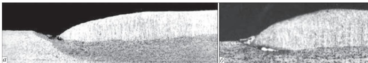
Рис. 1. Дефекты формирования валика при наплавке ленточным электродом: *a* — подрез; *б* — краевой непровар и шлаковое включение
