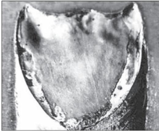
Рис. 2. Форма сварочной ванны при наплавке ленточным электродом 50×0,5 мм
