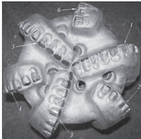
Рис. 2. Внешний вид износа вооружения и рабочих органов участков матричного долота диаметром 311,1 мм
