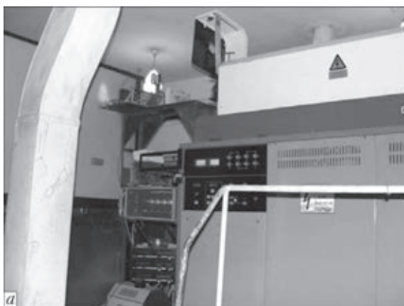
Рис. 11. Лазерная установка «Комета-2» (а) и схема устройства для ориентирования и перематки сварочной проволоки относительно лазерного пучка (б)
