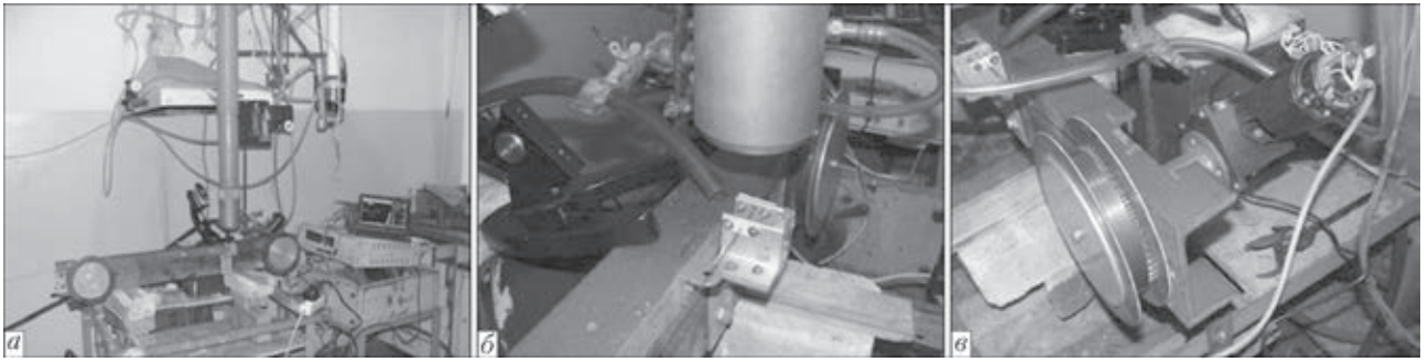
Рис. 12. Общий вид установки (а) и отдельных ее устройств, предназначенных для ориентирования (б) и перемотки (в) сварочной проволоки при обработке ее поверхности излучением \text{CO}_2 -лазера
