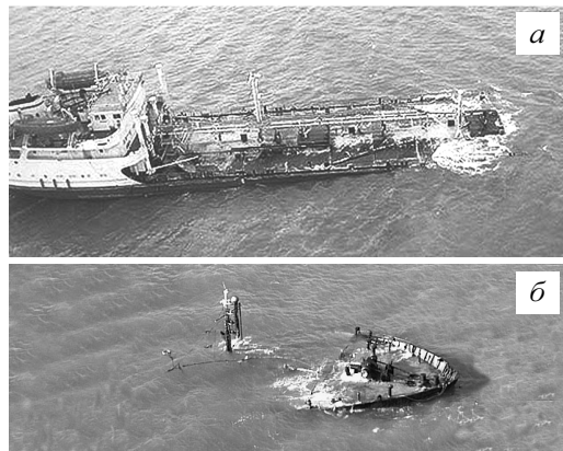
Рис. 11. Танкер «Волгонефть-139», разломившийся в Керченском проливе 11 ноября 2007 г.: а – кормовая часть; б – носовая часть (фото заимствовано из [94]).
