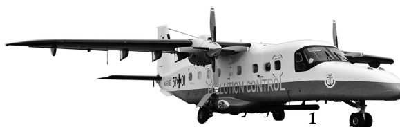
Рис. 2. Самолет экологического патрулирования Dornier Do-228 LM (Германия) [42]. Цифрой 1 обозначена антенна РЛС БО.
