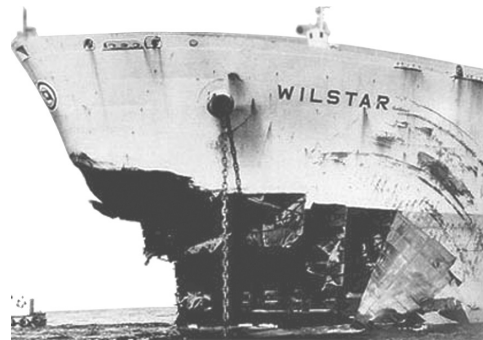
Рис. 10. Носовая часть танкера « Wilstar », поврежденная волной-убийцей.
