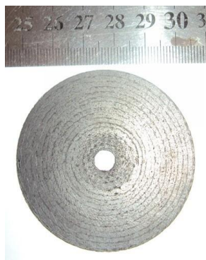
Рис. 4. Внешний вид слоистых композиционных материалов на основе вискозных углеродных волокон
