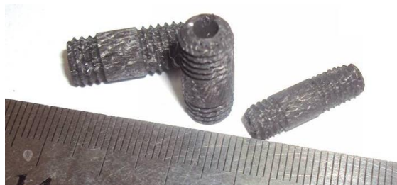
Рис. 3. Штильки из УУКМ на основе вискозы с резьбой М6 и М5 и внутренним каналом для ввода термопары
