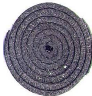
Рис. 5. Внешний вид слоистого образца после выгорания на воздухе при 900 °С
