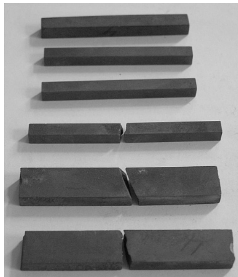
◀ Рис. 1. Керамические образцы для статических испытаний при трех- и четырехточечном изгибе.
