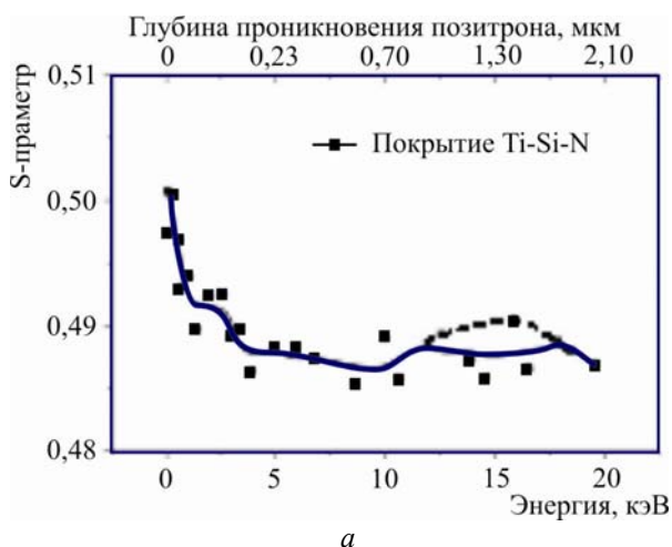
Рис. 4. Зависимость S-параметра от энергии микропучка позитронов: а – покрытие после осаждения; б – покрытие после отжига в вакууме при T = 600 \text{ °C} (30 мин)
