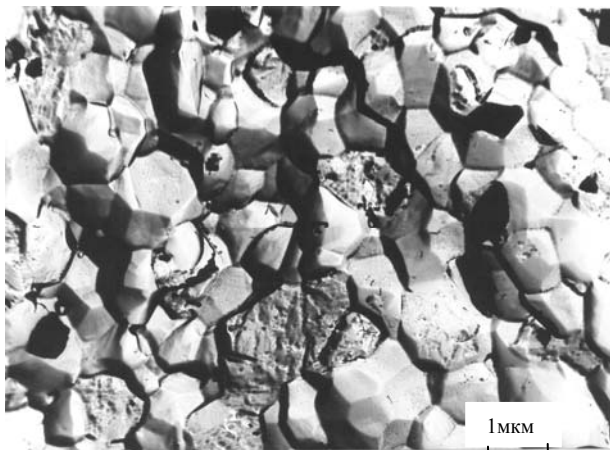
Рис. 4. Структура образца ZrO_2-3\% Y_2O_3 , полученного при температуре 1450 °C и давлении 40 МПа
