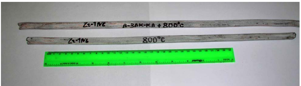
Рис. 1. Сплав Zr-1%Nb: фрагмент слитка доковки (а); прокованный до диаметра 32 мм от начальной температуры 1000 °С полуфабрикат (б); прутки послековки и прокатки при 800 °С на конечный диаметр 12 мм (88 %) (в)
