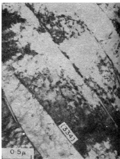
Рис. 6. Нелегированный Zr. \beta -закалка от 1000^\circ\text{C} в ледяную воду. ТЕМ-изображение структуры массивного мартенсита [28]
