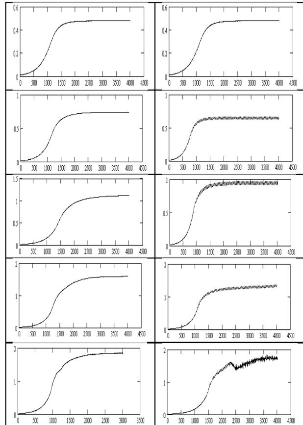
Рис.2. Зависимости амплитуд поля третьей гармоники от времени для значений расстройки  $\xi = 1.1, 1.2, 1.3, 1.4, 1.5$ . без учета нелинейности плазмы (левая колонка) и при наличии нелинейности плазмы (правая колонка)
