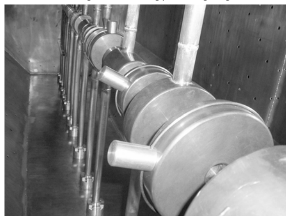
Рис.4. «Контрики», установленные в реальной ускоряющей структуре
