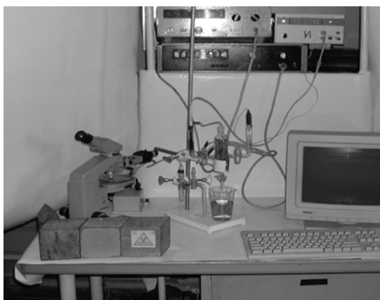
Рис. 2. Вид установки для потенциостатических измерений
