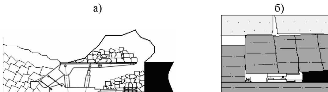
Рисунок 1 - Обрушение пород кровли в призабойном пространстве: а – мелкими фракциями, б – крупными блоками.
