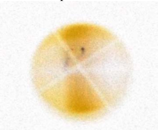
Рис.6. Фокусировка ионного пучка на сцинтиляторе с применением корректирующих обмоток
