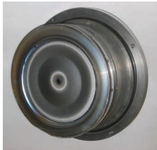
Рис. 2. Схема та фото магнетрона на постійних магнітах
