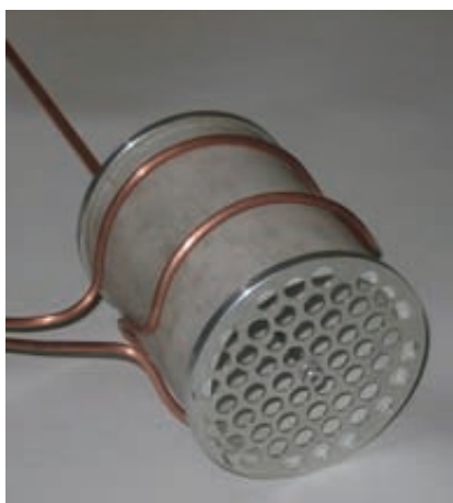
Рис. 4. Схема та фото джерела ВЧІ плазми
