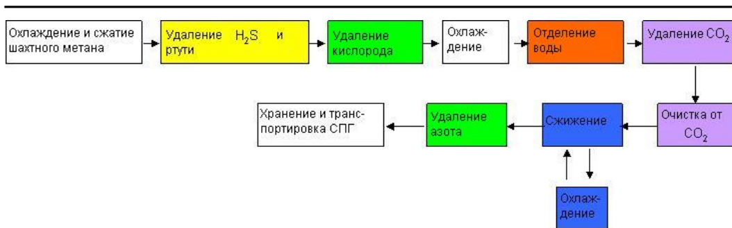
Рис. 7. Концепция утилизации ШМ путем сжижения на шахте Krupinski, Польша (Источник: LNG-Silesia Sp. z o.o.)
