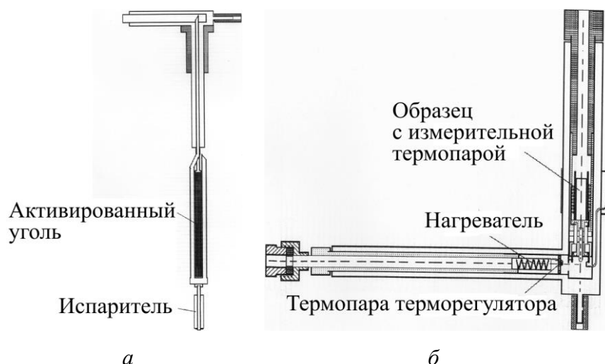
Рис. 9. Основные узлы проточного криостата: а – датчик потока хладагента располагаемый в транспортном сосуде Дьюара; б – криостат, сопрягаемый с автодинным детектором спектрометра в зазоре магнита
