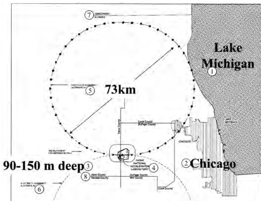
Рис. 9. Карта расположения комплекса VLHC: 1 – озеро Мичиган; 2 – Чикаго; 3 – глубина туннеля ускорителя; 4 – существующая лаборатория Фермилаб; 5 – вариант северного расположения туннеля VLHC; 6 – вариант южного расположения туннеля VLHC; 7 – границы штатов; 8 – границы графств
