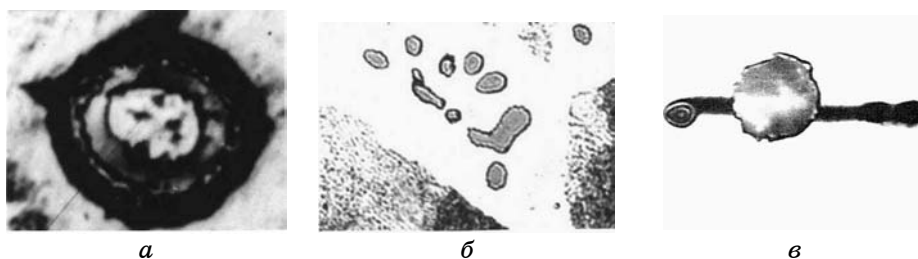
Рис. 8. Граничные фазы, возникшие при высокотемпературном нагреве вблизи включений \text{MnO} \cdot \text{Al}_2\text{O}_3 (а, в) и (\text{Fe}, \text{Mn})\text{S} (б); а — \times 20000 ; б, в — \times 900 \times 4 .
