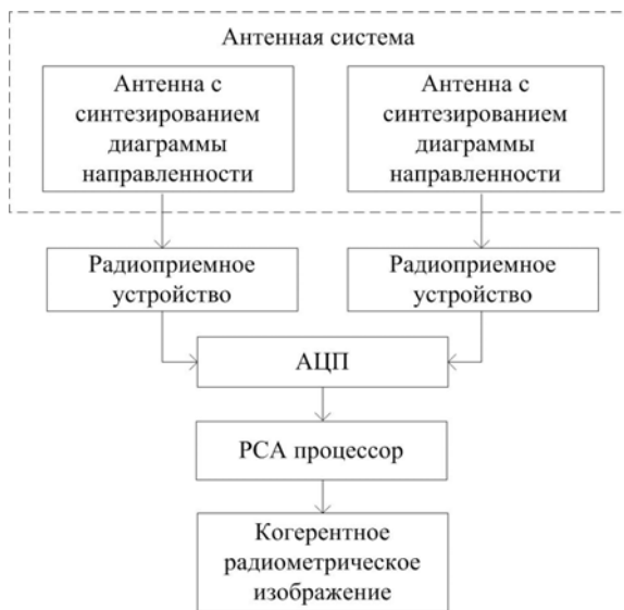
Рис. 1. Структурная схема наземного радиоинтерферометра с антеннами с синтезированной диаграммой направленности 8-мм диапазона длин волн
