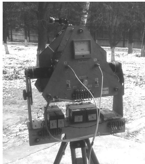
Рис. 1. Внешний вид измерительного радара
