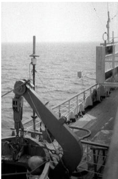
Рис. 1. Расположение вертикальной электрической СНЧ антенны на навигационной палубе НИС «Профессор Зубов»
