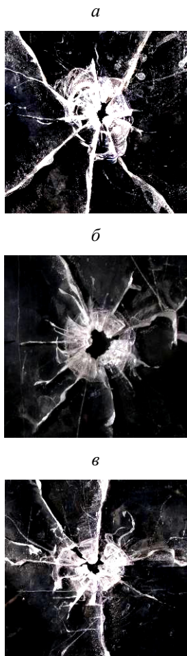
Рис. 1. Характер разрушения модели из органического стекла взрывом заряда ВВ различной формы: а – цилиндрическая; б – треугольная; в – квадратная
