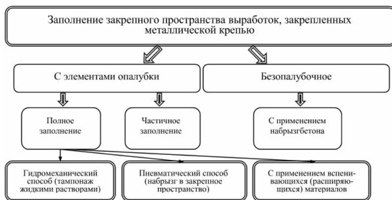
Рис. 1. Классификация технологии возведения крепи с заполнением закрепного пространства твердеющими составами
