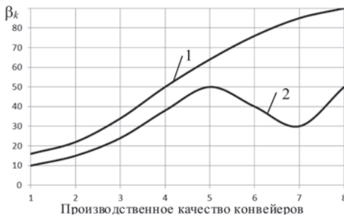
Рис. 1. Взаимосвязь предельных углов КНК различных конструкций в зависимости от крупности транспортируемого груза: 1 – мелкокусовой груз; 2 – крупнокусовой груз. Цифры по оси абсцисс соответствуют различным конструкциям КНК: 1-5 – конвейеры с рифленной лентой, с перегородками, с повышенной желобчатостью ленты, с прижимной лентой, с повышенной желобчатостью и прижимной лентой; 6-8 – конвейеры трубчатые, вертикальные с карманами, вертикальные со специальными сосудами
