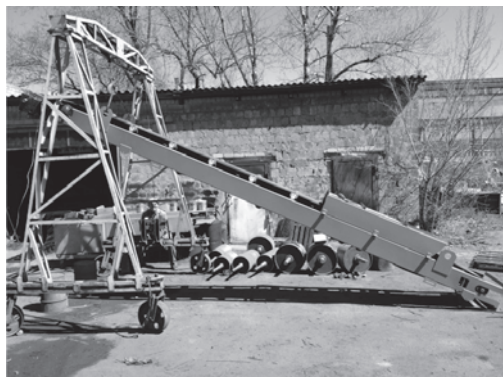
Рис. 5. Лабораторный стенд для определения устойчивости насыпного груза на ленте КНК
