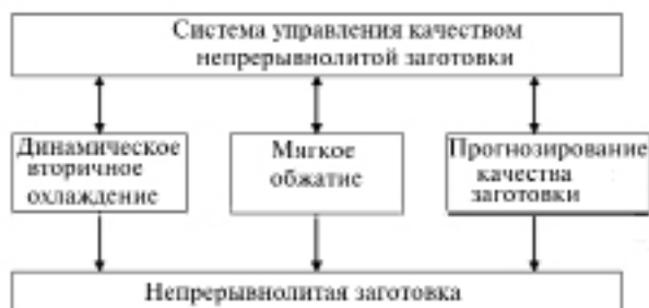
Рис. 1. Общая структурная схема системы управления качеством непрерывнолитой заготовки
