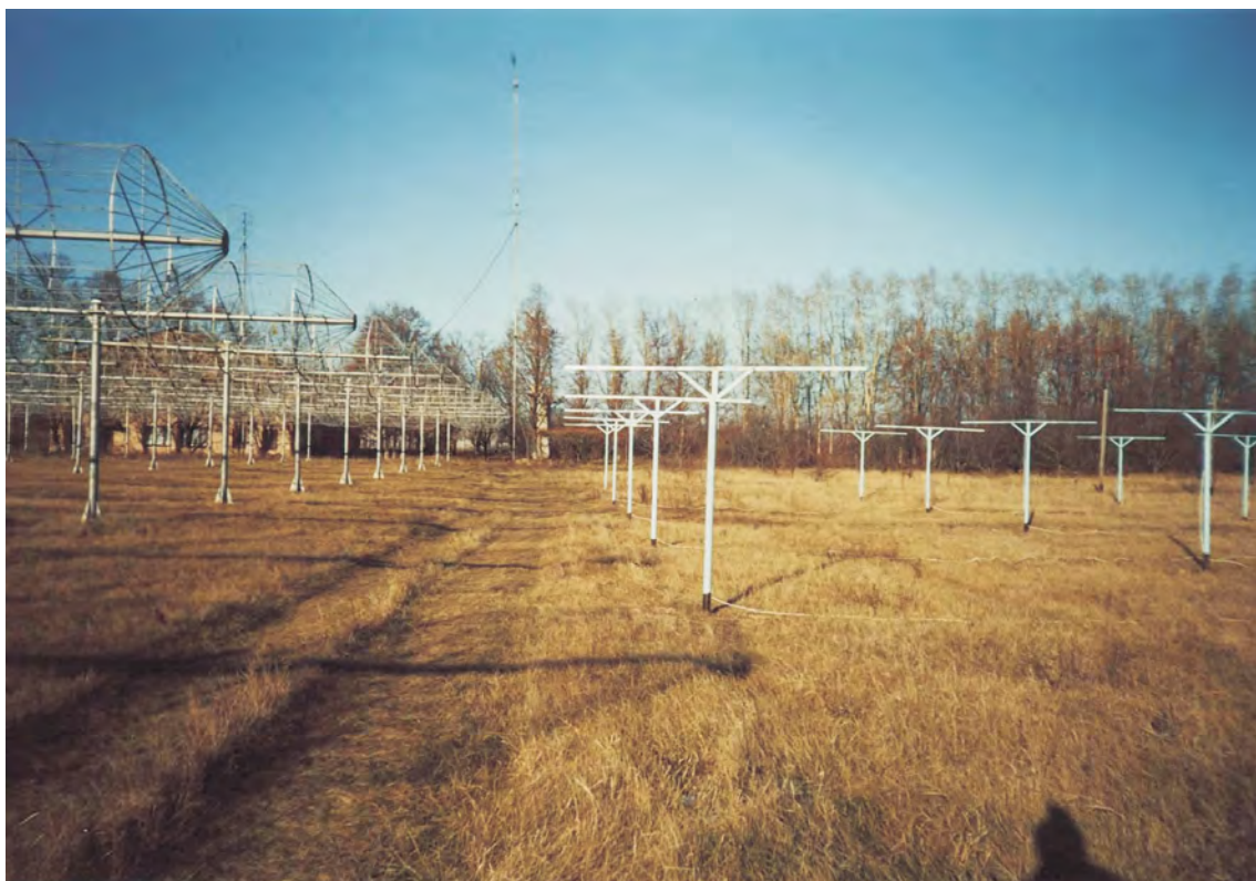
Рис. 10. 30-элементная антенна-решетка из активных диполей на обсерватории УТР-2
