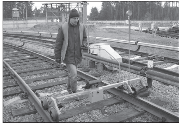
Рис. 11. Бесконтактная путьеизмерительная тележка КР-1П-КР с функцией контроля параметров подвески контактного рельса для метрополитена
