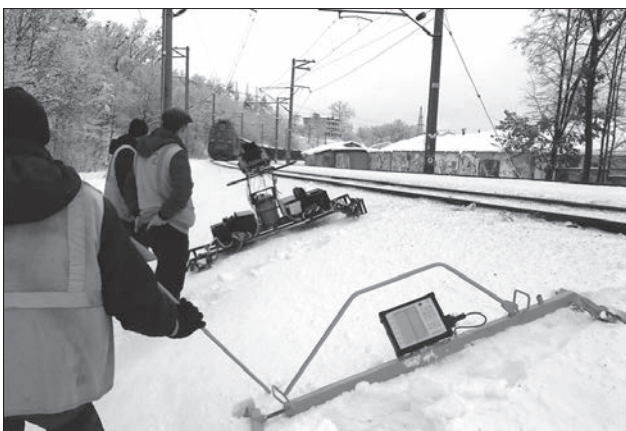
Рис. 9. Эксплуатационные испытания путьеизмерительной тележки КВ-1П в зимний период
