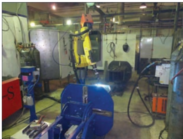
Рис. 3. Внешний вид роботизированной установки для сварки внутреннего контура котла
