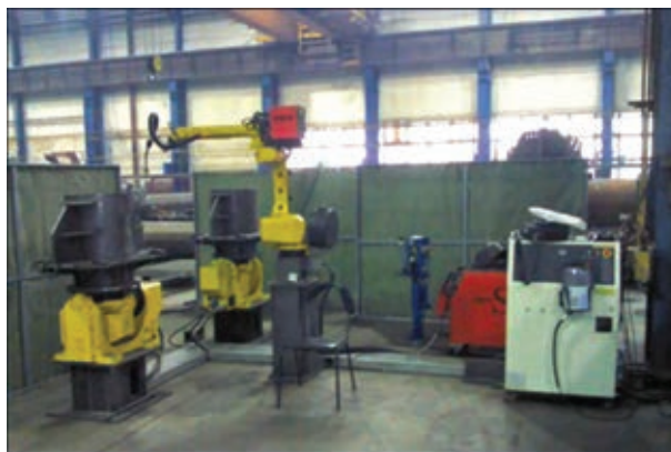
Рис. 2. Общий вид комплекса для сварки муфт
