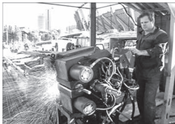
Рис. 6. Подвесная контактная стыковочная машина К813, адаптированная для сварки арматуры в условиях строительной площадки
