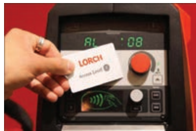
Процесс считывания информации с магнитной карточки
