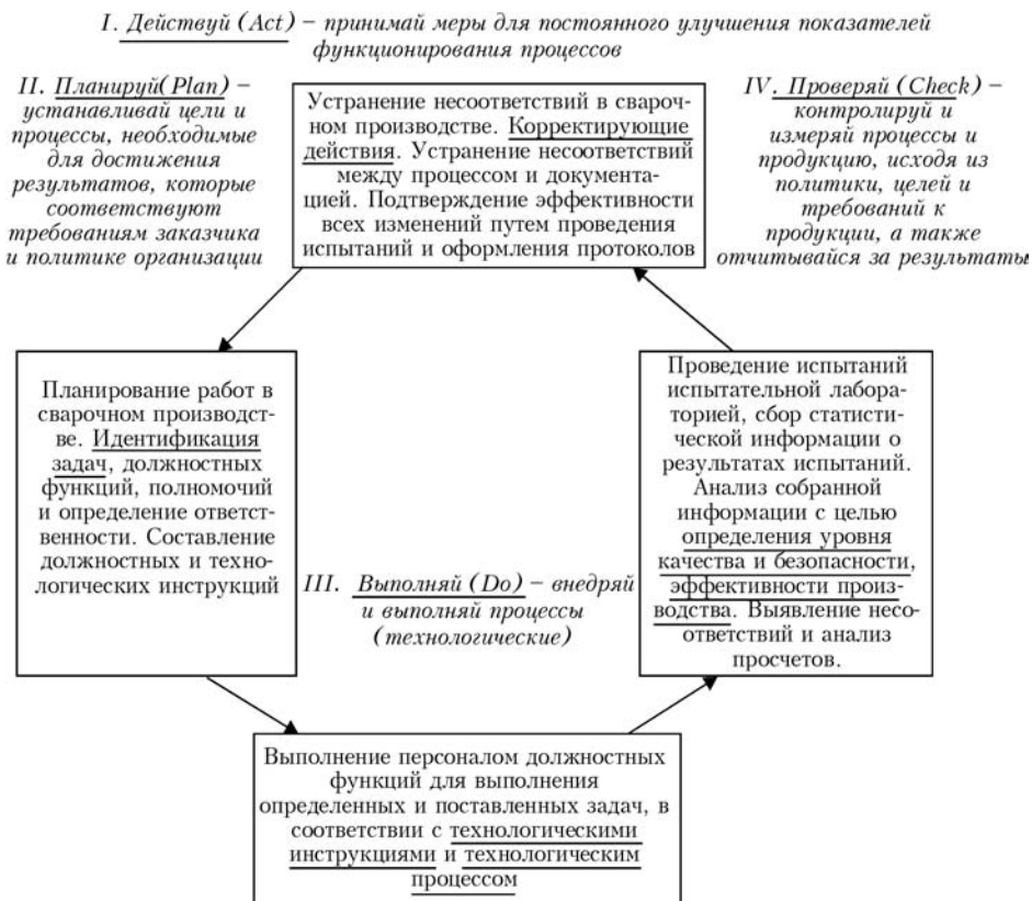
Рис. 5. Алгоритм эффективной координации сварочных работ согласно ISO 14731:1997 и ДСТУ ISO 9000-2001 [3]
